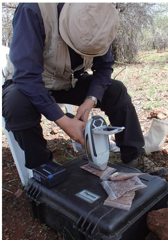
図8. 携帯型XRFによる測定の様子。
